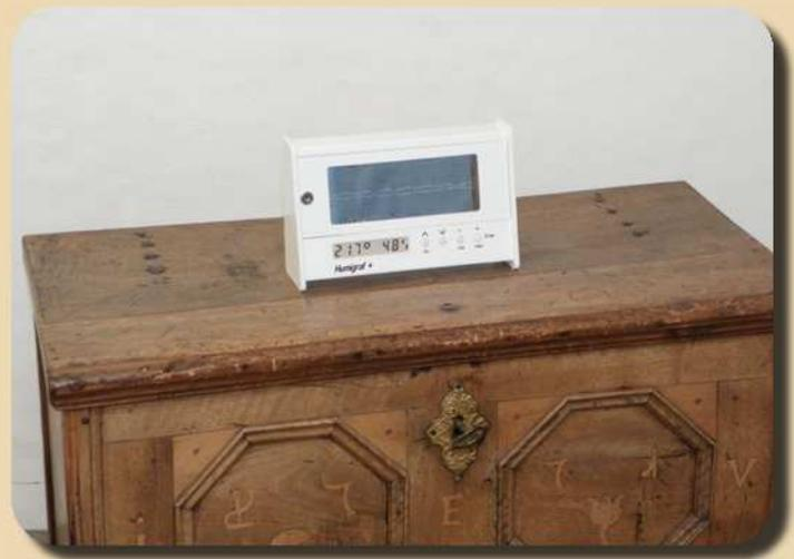
ist im Sichtfenster sofort sichtbar. Die kontinuierliche, rechtwinklige Aufzeichnung erfolgt ohne Tinte oder Faserschreiber (Kein bekleckern der Finger oder des Gerätes, keine Verschleißteile zum Auswechseln). Durch die rückseitige Anordnung der Schreibstifte lässt sich das Papier so einfach einlegen, wie früher der Rollfilm in eine Kamera. Eine Papierrolle reicht für die Aufzeichnung während eines ganzen Jahres. Das Papier kann mit einem wasserfesten Filzstift problemlos beschriftet werden.
