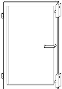
**Achtung:** damit der Schnappverschluss sicher arretiert, müssen die Grundplatte und der Winkel absolut parallel zum Fensterrahmen montiert werden.
