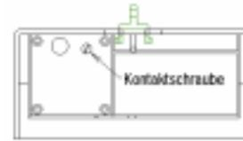
\* **Zwischenplatten:** Die Konstruktion der Einbruchsicherung ist für eine Stärke von 17 mm, des Fensterflügels ausgelegt. Ist der Fensterflügel dünner, muss die Differenz mit den Zwischenplatten beim Winkel ausgeglichen werden. Ist der Fensterflügel aber dicker, findet der Ausgleich mit den Zwischenplatten durch unterlegen bei der Grundplatte statt.
